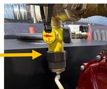
Système amorçage standard : pompe manuelle à membrane
